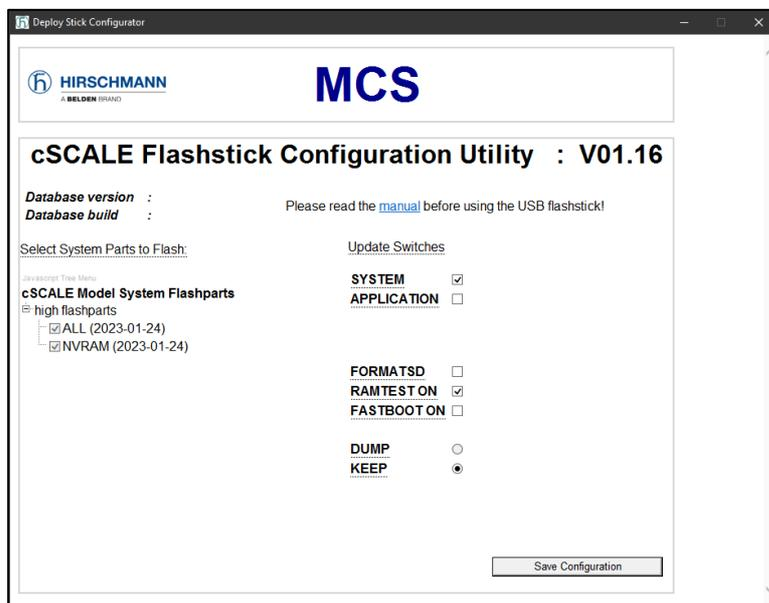
Vergewissern Sie sich, dass die Kästchen für die Flashparts "ALL" und "NVRAM" alle markiert sind. Vergewissern Sie sich, dass der Update-Schalter auf SYSTEM eingestellt ist. Speichern Sie die Konfiguration.
