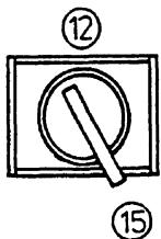
En esta posición (15), el interruptor llave de puente (12) desactiva la función de bloqueo de las palancas de maniobra del IMC. No afecta las otras funciones de visualización, indicación y alarma así como la función de bloqueo de palancas de maniobra del sistema final de carrera. El interruptor de puente está cargado por resorte para hacer volver el interruptor a la posición neutra (14). Por eso, se tiene que sujetarlo con el dedo durante la operación para activarlo.
