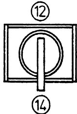
Voilà la position neutre (14) à laquelle l'interrupteur retourne à cause de son mécanisme chargé par ressort. Dans cette position, l'interrupteur de pontage n'a pas d'influence sur le blocage du CEC et des leviers de commande fin de course.
