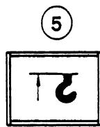
Folgende Kranbewegungen werden automatisch abgeschaltet: Hubwerk-Einziehen, Austeleskopieren, Abwippen. Bei Kranen mit Wippspitze wird außerdem das Abwippen der Wippspitze gestoppt.
