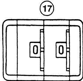
Der Kranführer muß die Rändelschalter (17) auf die ausgewählte Betriebsarten-Code-Nummer einstellen. Wird die Schalterposition geändert, werden die Kranbewegungen vom System vorübergehend abgeschaltet. Darüber hinaus leuchten die Warnlampen (5), (6) und (7) auf und der akustische Alarm (16) ertönt. Er kann durch Betätigung der Taste (7) abgeschaltet werden.
