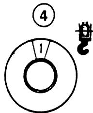
L'interrupteur du nombre de brins (4) fournit l'indicateur d'état de charge d'informations concernant le nombre de brins utilisé dans la moufle. L'interrupteur a 16 positions qui sont indiquées sous la petite fenêtre du sélecteur lorsqu'il est tourné.
