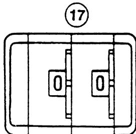
Le grutier doit ajuster les interrupteurs du code opératoire (17) au numéro code opératoire déterminé.
