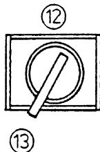
La posición (13) puentea el bloqueo de la palanca de maniobra del final de carrera. No influye el sistema IMC. La lámpara piloto roja (5) y la alarma acústica (16) para la condición inminente de final de carrera también van activadas cada vez. El interruptor llave de puente está cargado por resorte para hacer volver el interruptor a la posición neutra (14). Por eso, se tiene que sujetarlo con el dedo durante la operación para activarlo.
