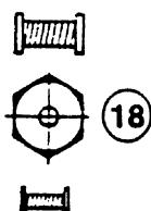
Mit diesem Kippschalter (18) wird dem LMB-System mitgeteilt, wie das Hubseil aufgelegt ist. Der Schalter hat zwei Positionen, die im folgenden näher beschrieben werden.
