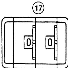
Der Rändelschalter (17) dient zur Betriebsarten-Einstellung des LMB-Systems entsprechend der Krankonfiguration.
