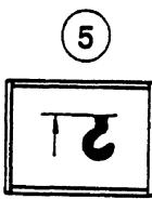
Cette lampe témoin rouge (5) s'allume lorsque les contacts de l'interrupteur s'ouvrent signalant que l'on s'approche d'une condition fin de course. L'alarme sonore résonne en même temps.
