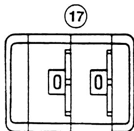
Cambiada la posición del interruptor, el sistema corta los movimientos de la grúa por el momento. Además, se encienden las lámparas de alarma (5), (6) y (7) y suena la alarma acústica (16). Se puede parar la alarma acústica pulsando el botón (7).
