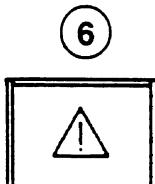
Esta lámpara amarilla (6) se enciende cuando la carga elevada por la grúa está dentro del 90 y 100% de la capacidad, indicando que la grúa se acerca a una condición de sobre-carga.
