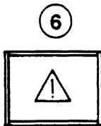
Cette lampe jaune (6) s'allume lorsque la charge agissant sur la grue est entre 90 et 100% de la capacité nominale, elle indique que l'on s'approche d'une condition de surcharge.
