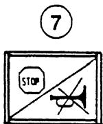
Dieses Bedienelement (7) hat zwei Funktionen. Erstens ist es eine rote Warnlampe, die aufleuchtet, wenn der Kran die zulässige Nenntraglast der Traglasttabelle erreicht hat. Zweitens kann durch Drücken der Taste der akustische Alarm für 15 Sekunden abgeschaltet werden.
