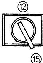
In dieser Stellung (15) unterdrückt der Überbrückungsschalter (12) die Abschaltfunktion der LMB. Alle anderen Anzeige- und Alarmfunktionen sowie die Abschaltfunktion des Hubendschaltersystems sind weiterhin aktiviert. Der Überbrückungsschalter ist federbelastet, damit er selbstständig in die neutrale Stellung (14) zurückspringt. Deshalb muß dieser Schalter zur Aktivierung festgehalten werden.
