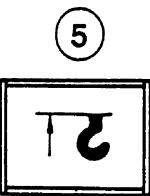
Esta lámpara piloto roja (5) se enciende cuando los contactos del interruptor final de carrera se abren indicando que la grúa se acerca a una condición de final de carrera, simultáneamente, suena la alarma acústica.
