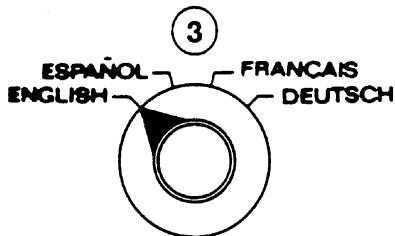
Después del arranque de la grúa, cuando el sistema ha terminado el autotest sin errores, la consola indica esta frase alternativamente en las 4 lenguas. El gruista puede marcar la lengua deseada con el interruptor (3). La lengua no influye el funcionamiento del sistema.
