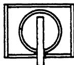
L'élément (12) est un interrupteur qui peut être activé seulement par clé. Cet interrupteur à clé de pontage peut désactiver la coupure CEC ou fin de course pour l'instant pour permettre au grutier de ponter le blocage des leviers de commande. L'interrupteur de pontage chargé par ressort a 3 positions qui sont décrites ci-dessous.
