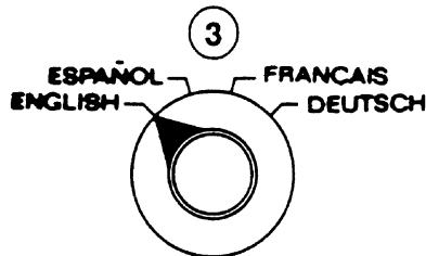
Nach dem Anlassen des Kranes und dem Durchlauf des automatischen LMB-Tests ohne Fehlererkennung zeigt die Konsole die nebenstehende Nachricht abwechselnd in 4 Sprachen an. Mit Schalter (3) kann der Kranführer die von ihm gewünschte Sprache auswählen. Die Sprache hat keinen Einfluß auf die Systemfunktionen.
