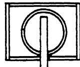
El elemento (12) es un interruptor que puede ser activado sólo con una llave. Este interruptor llave de puente puede desactivar momentáneamente el bloqueo del IMC o del final de carrera para dar al operador la posibilidad de puentear el bloqueo de las palancas de maniobra. El interruptor de puente cargado por resorte tiene 3 posiciones que se detallan a continuación.
