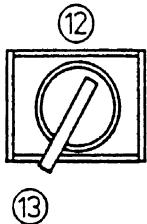
La position (13) pente le blocage des leviers de commande de fin de course. Elle n'a pas d'influence sur le système CEC. La lampe témoin rouge (5) et l'alarme sonore (16) pour les conditions fin de course imminent sont activées également chaque fois. L'interrupteur à clé est chargé par ressort afin de le faire retourner à la position neutre (14). Pour cette raison, il est nécessaire de le retenir avec le doigt pendant son activation.
