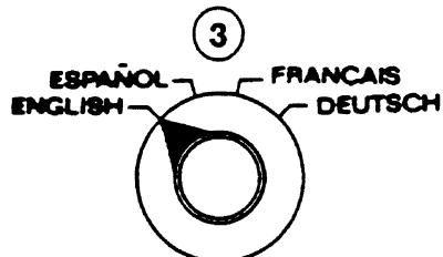
Après le démarrage de la grue et lorsque le système a terminé sans défauts le contrôle automatique, le pupitre affiche cette phrase alternativement en toutes les 4 langues. Le grutier peut choisir la langue requise à l'aide de l'interrupteur (3). La langue n'a pas d'influence sur le fonctionnement du système.
