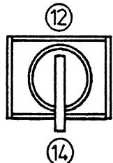
Diese Position ist die neutrale Stellung (14) des Schlüsselschalters, in die er zurückspringt, da er als Taste ausgeführt ist. In dieser Stellung hat der Schalter keinen Einfluß auf die LMB- oder Hubendschalter-Abschaltfunktion.
