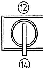
Esto es la posición neutra (14) a la que vuelve el interruptor debido al mecanismo cargado por resorte. En esta posición, el interruptor de puente no influye el IMC y el bloqueo de las palancas de maniobra del final de carrera.
